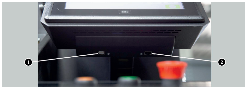
Рисунок 4. Расположение разъёмов USB и LAN
